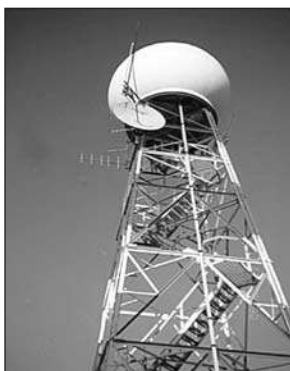
Fig.1 Radar meteorológico tipo doppler.
