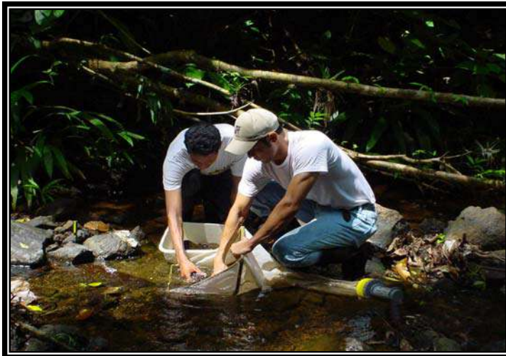
Fig. No. 4: Colecta de los insectos acuáticos usando el “muestreador surber”.
